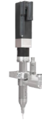
Exzenterschneckendosierer dos screw Punktueller Dosierung ab 15 µl und endloser Raupenauftrag mit einer Geschwindigkeit von bis zu 600 ml/min.
